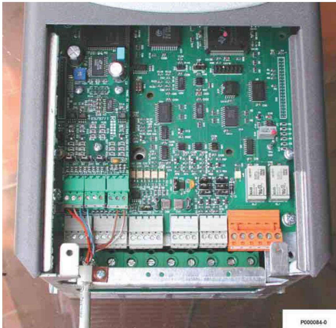
Fig. 70: Wiring the Encoder
